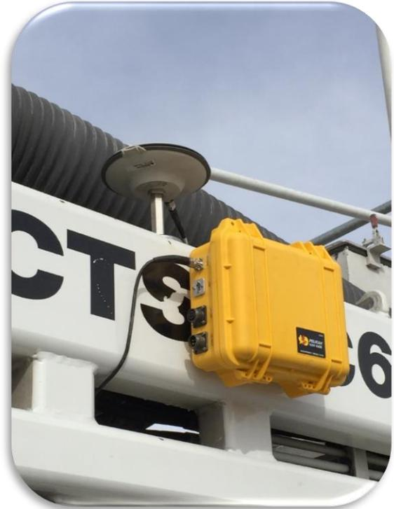
▲ Antena GPS y Módulo en un PC-6000 ▲
